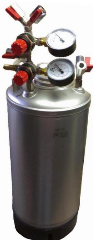
Serbatoio completamente in acciaio inox, bocca riempimento tipo passamano, chiusura autoclave, regolazione pressione prodotto e regolazione pressione all'utilizzo tramite doppio riduttore, omologato CE.
