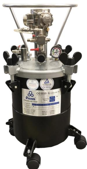
Serbatoi 10 - 20 - 40 - 60 - 80 Lt. completamente teflonati, con apertura totale, regolazione pressione prodotto, secchia interna in inox, ruote e agitatore pneumatico.
